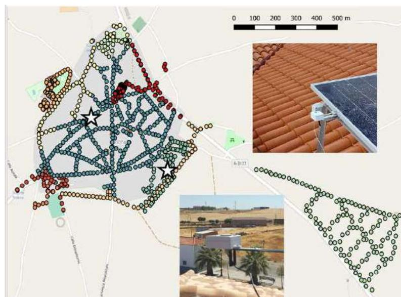
Figura 13. Mapa del alumbrado público de Añora y localización de las estaciones desde donde miden los fotómetros (marcado con una estrella). La codificación de colores indica los conjuntos de luminarias controladas por el mismo cuadro de mando.
